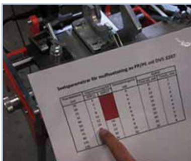
Kontroller sveiseparametere iht. DVS 2207
